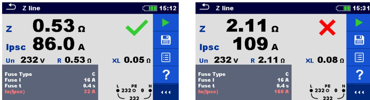
Abbildung 7.40: Beispiele für Ergebnisse der Leitungsimpedanz-Messung
