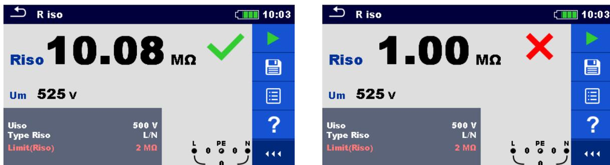
Abbildung 7.9: Beispiele für Ergebnisse der Isolationswiderstandsmessung
