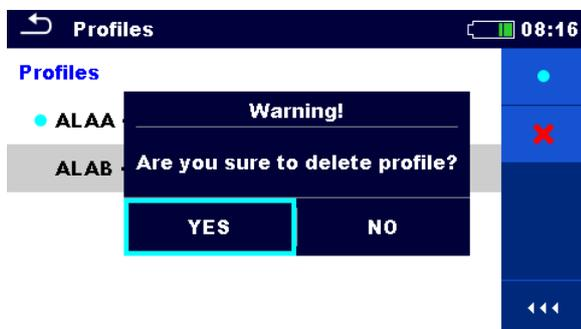
Vor dem Löschen des ausgewählten Profils wird zur Bestätigung aufgefordert.
