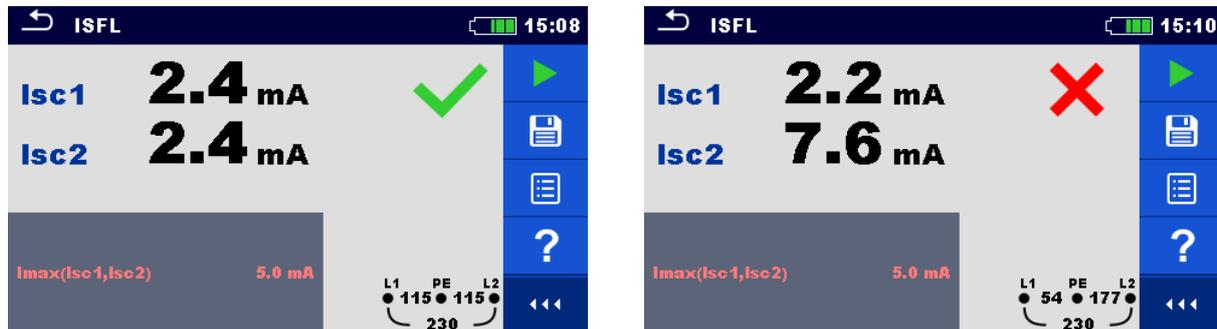
Abbildung 7.70: Beispiel für die Messergebnisse des ersten Fehlerableitstroms
