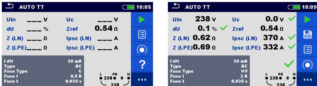
Abbildung 8.5: Beispiele für Ergebnisse der AUTO TT Messung
