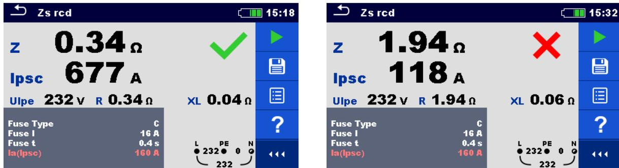
Abbildung 7.33: Beispiele für Ergebnisse der Zs rcd Messung
