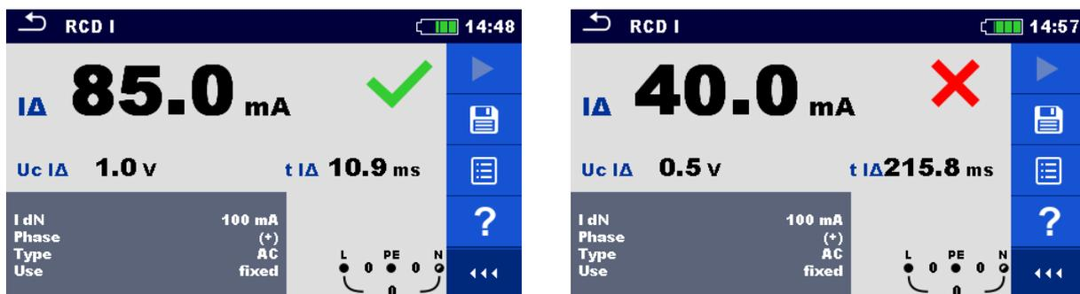
Abbildung 7.26: Beispiel für die Messergebnisse des Auslösestroms
