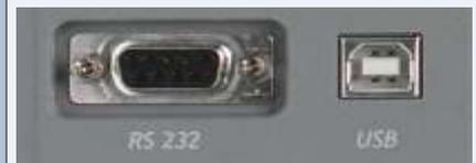
TeraOhm 10 kV verfügt über eine RS232- und USB- Schnittstelle. Die im Gerät gespeicherten Messergebnisse können auf einen PC übertragen werden.
