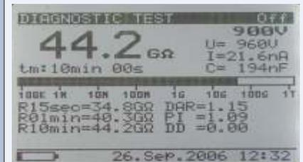
Bei der kompletten Isolationsdiagnose werden gleichzeitig Isolationswiderstand, PI bzw. DAR und DD dargestellt. Damit kann der Isolationszustand schnell und zuverlässig beurteilt und entsprechende Wartungsmaßnahmen unternommen werden.
