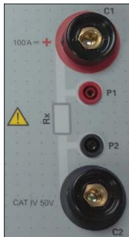
Abbildung 4.2: MicroOhm Strom- und Spannungsanschlüsse
