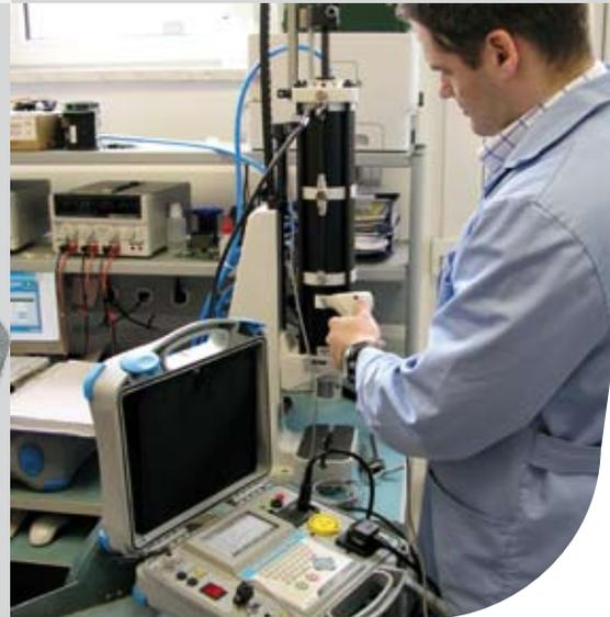
Das Spitzengerät ermöglicht die Prüfung der elektrischen Sicherheit für Betriebsmittel, IT-Geräten, IEC-Leitungen sowie tragbaren FI- Schutzeinrichtungen nach den jeweiligen standardisierten IEC-, EN- und VDE-Vorschriften.
