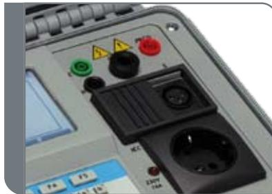
Anschlussfeld – Prüfanschlüsse für fest installierte Geräte.
