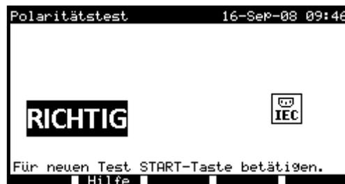
Beispiel eines Ergebnisses der Polaritätsprüfung
