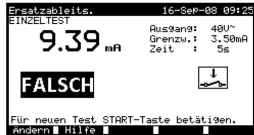
Beispiele von Ergebnissen der Messung des Ersatzableitstroms
