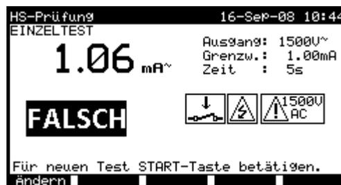
*Beispiele von Ergebnissen der Hochspannungsprüfung*
