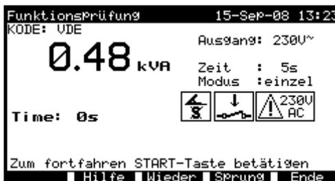
*Funktionsprüfung – Messung des Scheinstroms*
