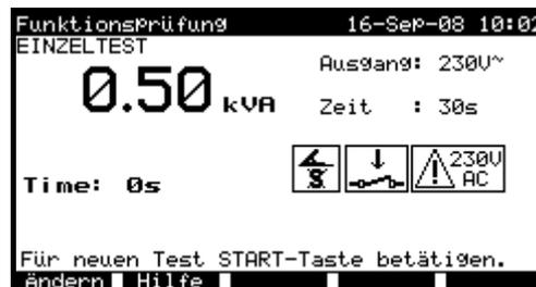
*Beispiel eines Ergebnisses der Messung des Scheinstroms***Hinweise:**
