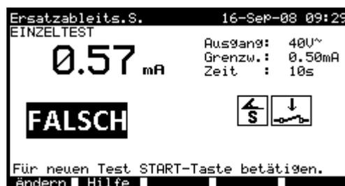
Beispiele von Ergebnissen der Messung des Ersatzableitstroms
