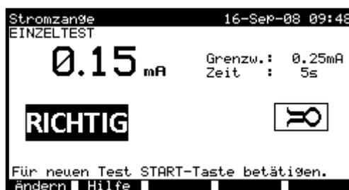
*Beispiel eines Ergebnisses der Messung des Zangenstroms*
