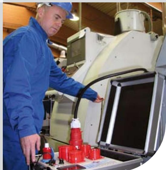
**TRIDELTA GT ist ein kompletter VDE 0701/0702 Gerätetester zum Testen von Dreh- und Wechselstromverbrauchern mit einer Anschlussleistung bis 25 kW gemäß Betriebssicherheitsverordnung bzw. BGV A3.**
