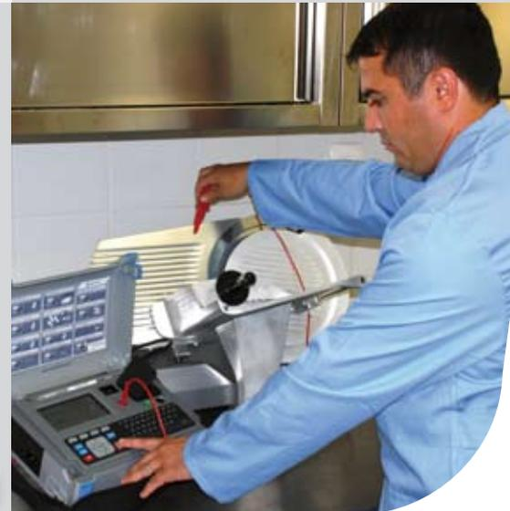
Das tragbare Multifunktionstest-Instrument MI 3310A und MI 3310 SigmaGT ist in der Lage, alle für die Sicherheit von tragbaren elektrischen Geräten erforderlichen Prüfmessungen durchzuführen. Die Bedienung des Geräts ist einfach und intuitiv. Das Instrument verfügt über ein leistungsfähiges Testdaten-Managementssystem mit ca. 6000 Möglichkeiten zur Speicherung der Autotest- und Einzeltestdaten.
