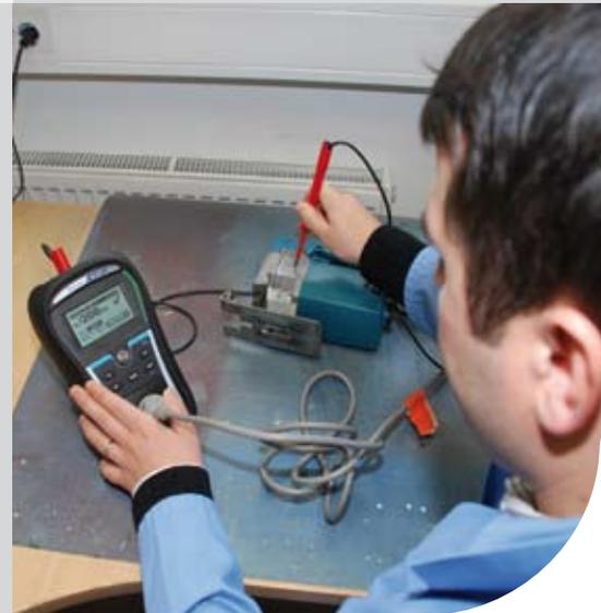
Der neue MI 3311 GammaGT ist ein netzunabhängiges Multifunktionsgerät zum Prüfen der elektrischen Sicherheit von ortsveränderlichen elektrischen Geräten. Dank des großen grafischen LCD-Displays mit Hintergrundbeleuchtung, zwei GUT / SCHLECHT-LED-Anzeigen sowie einem Stromlaufplan mit Anschlußschema für jede Messung, ist die Bedienung des Instruments klar und einfach.
