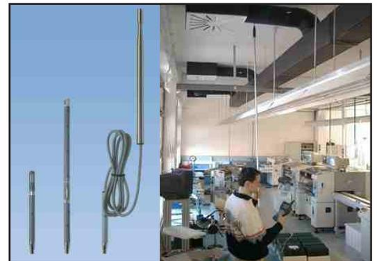
Prüfung der Belüftung von Klimaanlage (Luftgeschwindigkeit, Temperatur, relative Luftfeuchte mit dem Universal- Mikroklimafühler)
