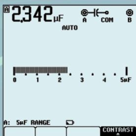
Prüfen des Startkondensators eines Motors mit dem ScopeMeter der Serie 120
