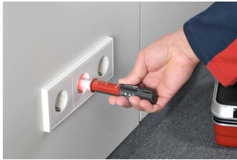
Überprüfung von Steckdosen auf Wechselspannung und Polarität
