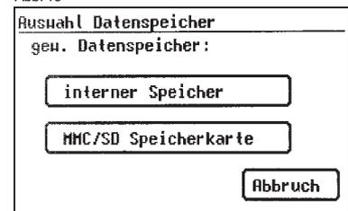
Sollte die Speicherkarte oder der interne Speicher vollständig gelöscht werden, so drücken Sie im Konfigurationsmenü (Seite 2) die **Funktionstaste [Löschen]** (Abb. 12) und bestätigen die Sicherheitsabfragen.
