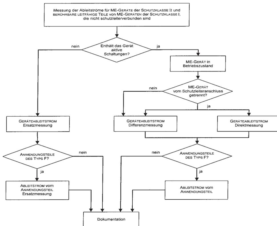
**16. Durchführen von Prüfungen mit dem Gerätetester GT-0751 nach DIN VDE 0751-1, Beispiel 1: Geräte mit Schutzleiter (SK I) und Anwendungsteil Typ B**
