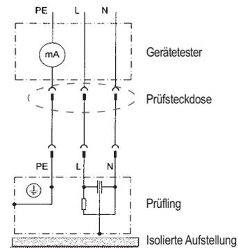
Schutzleiterstrom – Differenzstromverfahren SK I, Bild M6
