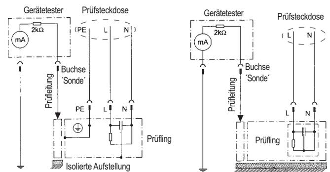
Messung an allen berührbaren leitfähigen Teilen des Prüflings, die nicht mit dem Schutzleiter verbunden sind
