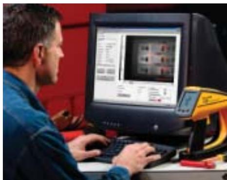
Übertragen Sie die Aufnahmen mit Hilfe der Analyse- und Berichtssoftware *InsideIR* auf einen PC.
