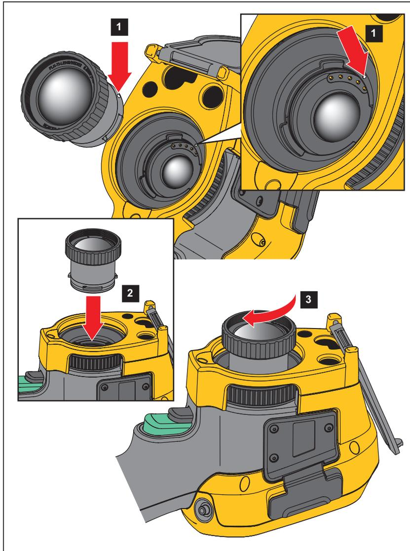
Abbildung 2. Anbringen eines optionalen Objektivs
