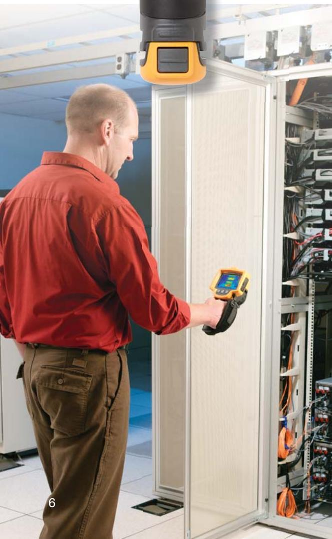
**Farbpalette**—Farbliche Darstellung von Temperaturen (Temperaturskala) in einem Bild. Farbpaletten können benutzerspezifisch angepasst werden und optimieren das Bild für verschiedene Anwendungen und/oder Problembereiche.
