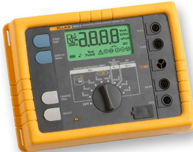
dem Erdungsmesser verbunden. Es werden keine Erdungsspieße verwendet. Über eine der Zangen wird eine bekannte Festspannung induziert, und mit der zweiten Zange wird der Strom gemessen. Dann ermittelt das Messgerät automatisch den Widerstand des Tiefenerders.
