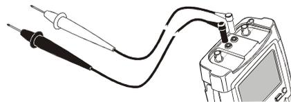
**Abbildung 41. Manuelles Abtasten für Meter-Messungen mittels 2-mm-Prüfspitzen**
