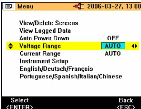
Abbildung 12. Spannungsbereichseinstellungen
