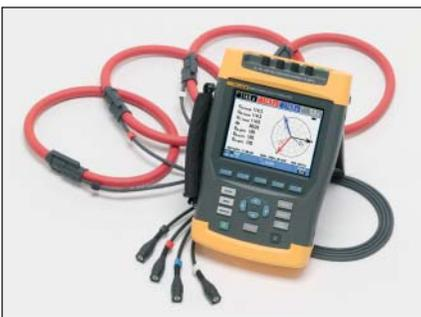
Fluke 435 mit Flex-Stromzangen
