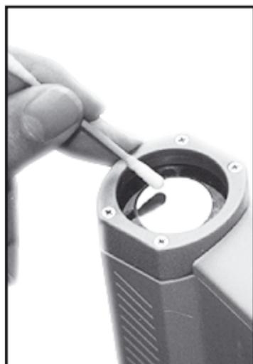
Gehäusereinigung: Je nach Verunreinigung mit trockenem oder feuchtem (nicht tropfnassem) Tuch oder Schwamm abwischen.
