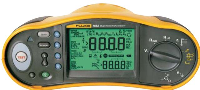
Zur Prüfung der Schutzmaßnahmen wie oben beschrieben bezieht sich IEC 60364.6.61 auf IEC / EN 61557.
