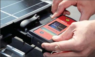
„SENSOR“ in einer Ebene mit Modulen montieren und die Einstrahlung messen.
