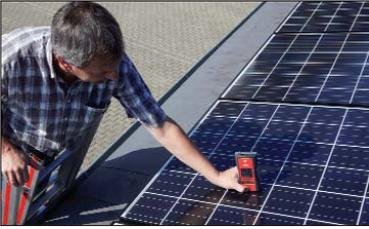
Mit dem „SENSOR“ die Oberflächentemperatur der Module messen.
