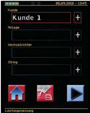
Durch das Betätigen der Taste „+“ neben dem jeweiligen Textfeld, können neue Daten eingegeben werden. Für eine bequeme Dateneingabe können Sie den SOLAR-4000 ANALYZER um 90° drehen.
