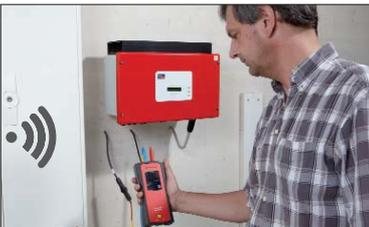
Drahtlose Übertragung der Messwerte vom „SENSOR“ auf den „ANALYZER“.
