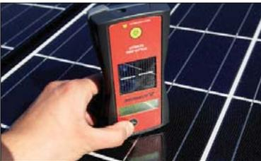
Erneute Messung der Oberflächentemperatur mit dem „SENSOR“.
