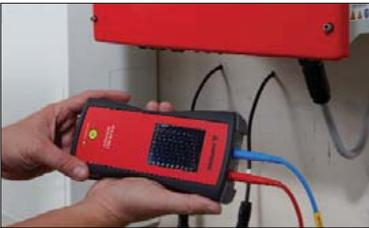
Mit dem „ANALYZER“ Leerlaufspannung und Kurzschlussstrom messen und Strom-/Spannungskennlinie der Anlage ermitteln.
