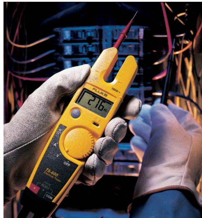
einer Hand bedienen und mit dem Daumen zwischen Volt, Ampere und Durchgang umschalten. Dieses einfache Umschalten trägt enorm zu einer schnelleren Fehlersuche bei.“
