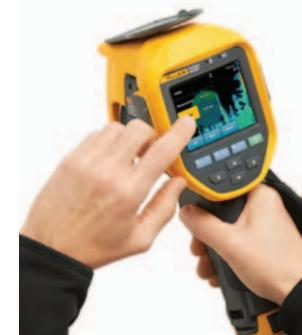
Die Kameras der Professional Serie sind mit einem 8,9 cm (3,5") großen HD-Touchscreen mit einer Auflösung von 640 x 480 Pixel ausgerüstet, auf dem Probleme mühelos erkennbar sind. Die intuitive Bedienung erleichtert den schnellen Wechsel zum nächsten Bild oder die Umschaltung der Betriebsart. Außerdem ermöglichen die großen Tasten die Einhandbedienung der Kamera, sogar mit Handschuhen.
