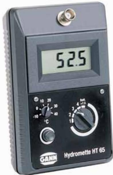
Die HT 65 ist ein elektronischer **Holzfeuchtemesser** nach dem Widerstands-Messprinzip für Präzisionsmessungen von **Schnittholz** (bis 180 mm Stärke), **Spanplatten**, **Furnieren sowie Hackschnitzeln** und ähnlichen Schüttgütern durch Einzelmessungen vor und nach der Verarbeitung. Zusätzlich wird über die einstellbare **Holztemperatur-Kompensation** eine Optimierung des Messwertes erreicht. Besonders geeignet für Sägewerke, Parkettfabriken und Holzverarbeitende Betriebe.
