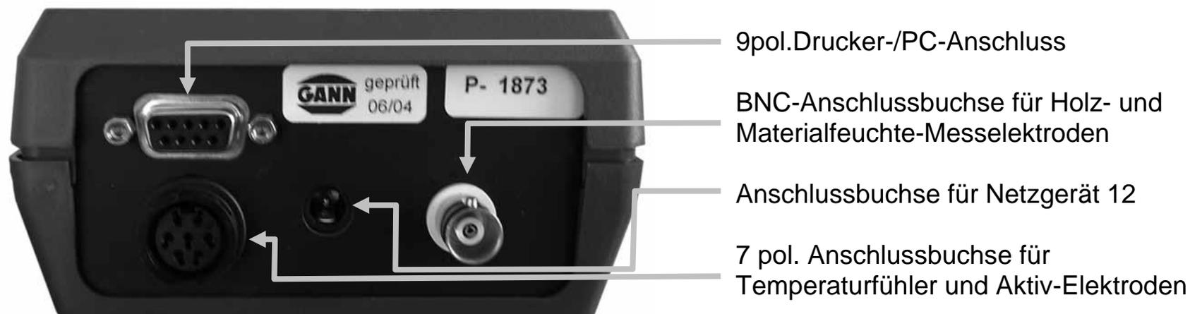
Für den Anschluss an einen Drucker oder PC sind Spezialkabel (MK 17 bzw. MK 19) erforderlich, die als Sonderzubehör lieferbar sind. Bei längeren Datenübertragungen an einen Drucker oder PC ist zur Schonung der Batterie der Einsatz des Netzgerätes 12 zu empfehlen. Für die Holzfeuchte-, Materialfeuchte-, Luftfeuchte- und Temperaturmessung können alle Messelektroden des GANN Hydromette-Programms verwendet werden.
