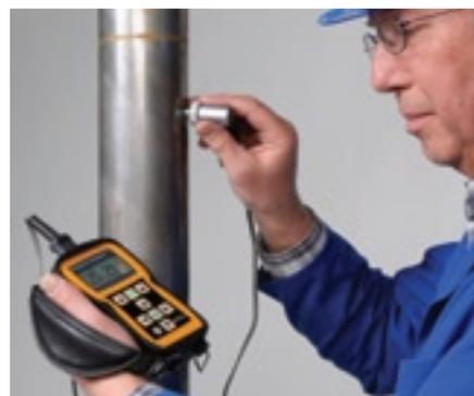
Ultraschall-Wanddickenmessung an Rohren mit dem DM5E
