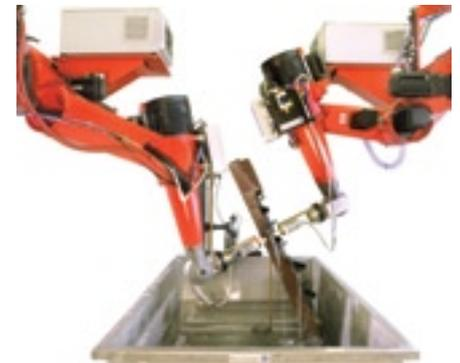
Phased-Array-Sqirter mit Robotern
