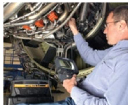
Überprüfung eines Flugzeugmotors mittels XLG3™ VideoProbe
