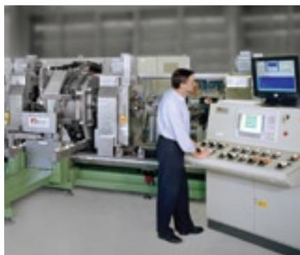
ROTA-Ultraschallprüfsystem für Stangen und Rohre
