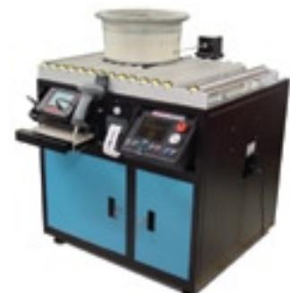
Flugzeugradprüfung mit WheelScan 5
