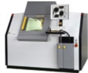
nanome|x CT System zur Prüfung elektronischer Komponenten
