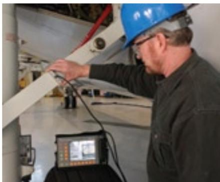
Prüfung von Flugzeugkomponenten mit dem Phasor XST™-Phased-Array-Ultraschallprüfgerät
