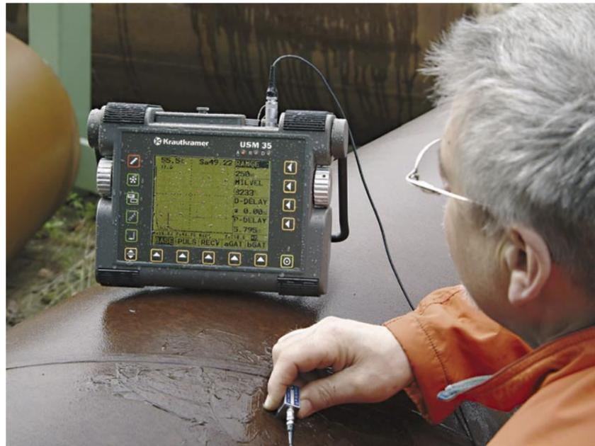
Prüfung einer Schweißnaht
