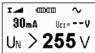
Bild 3.2 Anzeige von (Fremd-) Spannung  $> 255\text{ V}$
