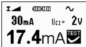
Bild 3.20 Ergebnis Auslösestrommessung
