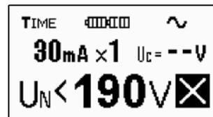
Bild 3.15 Beispiel: Einstellung zur Auslösezeitmessung
