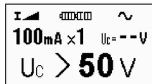
Bild 3.5 Berührungsspannung  $> 50\text{ V}$
