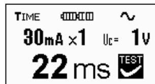
Bild 3.16 Ergebnis der Auslösezeitmessung
