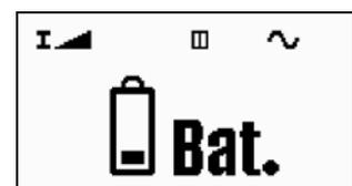
Bild 3.9 Zustand der Batterie nach Drücken von **START**
