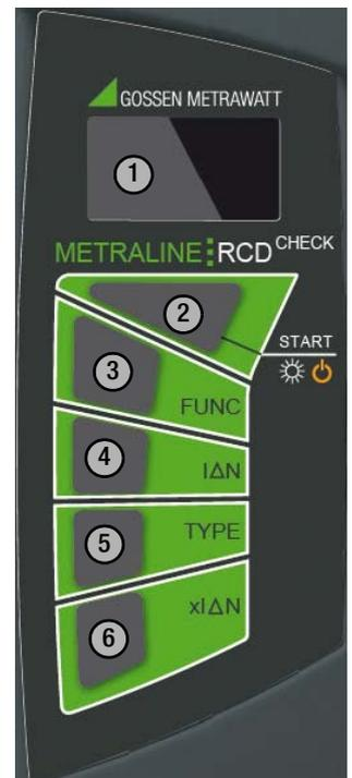
Bild 2.3 Bedienfeld und OLED Display
