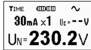
Bild 3.4 Beispiel Spannungsmessung
