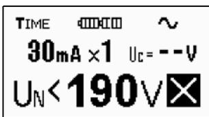
Bild 3.1 Anzeige von (Fremd-) Spannung  $< 190\text{ V}$
