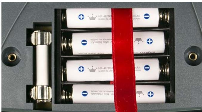
Bild 5 Korrekte Polarität der Zellen
