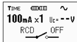
Bild 3.7 Beispiel der angezeigten Auslösung bei Berührungsspannungsmessung
