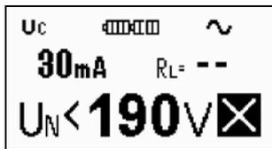
Bild 3.12 Beispiel: Einstellung zur Messung der Berührungsspannung
