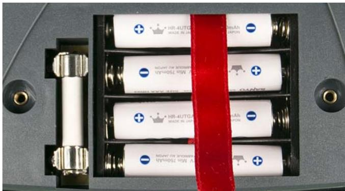
Bild 6.1 Korrekte Polarität der Zellen
