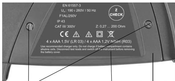
Schrauben des Batteriefachdeckels
