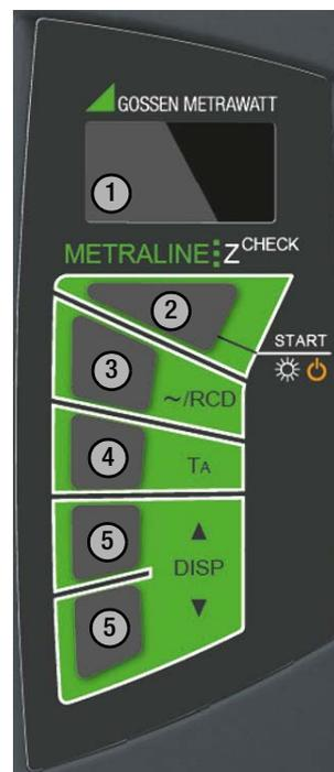
Bild 2.3 Bedienfeld und OLED Display
