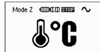
Bild 3.11 Anzeige der Temperaturüberschreitung, nach Drücken der Taste START
