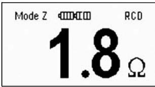
Bild 3.21 Impedanz hinter einem FI (kurz)
