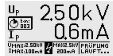
Die Hochspannung wird jetzt auf die Prüfspitzen geschaltet.
