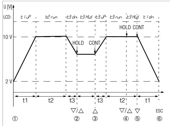
**Rampenparameter:** Ausgangsgröße: U (Bereich 0 ... 15 V),
