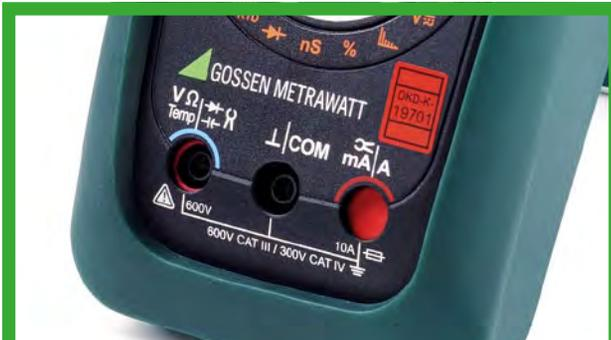
Die automatische Buchsen-Sperre verhindert den falschen Anschluss der Messleitungen bzw. die falsche Wahl der Messgröße.
