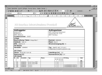
**ASi.doc-win** liest die Daten der AS-i-Bustester und blendet die Anlagenkonfiguration in ein WORD-Formular ein, das ergänzt und ausgedruckt werden kann.
