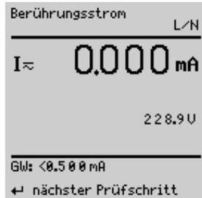
Sofern eine Ersatz-Ableitstrommessung an den CEE-Dosen 1, 2, 3 oder der Kaltgerätesteckdose 5 durchgeführt werden soll, muss der Schalter nur für diese Prüfung in Stellung „DOSE 4“ geschaltet werden. Bei Auswahl von Differenzstrommessung oder Ersatz-Ableitstrommessung, Ersatz-Ableitstrommessung auswählen, siehe Ablauf „DOSE 4“.
