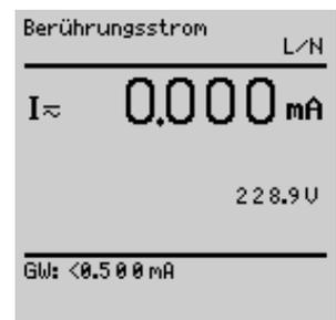
Gemessen wird der Effektivwert. Über die Taste werden AC- und DC-Anteile des Stroms angezeigt.
