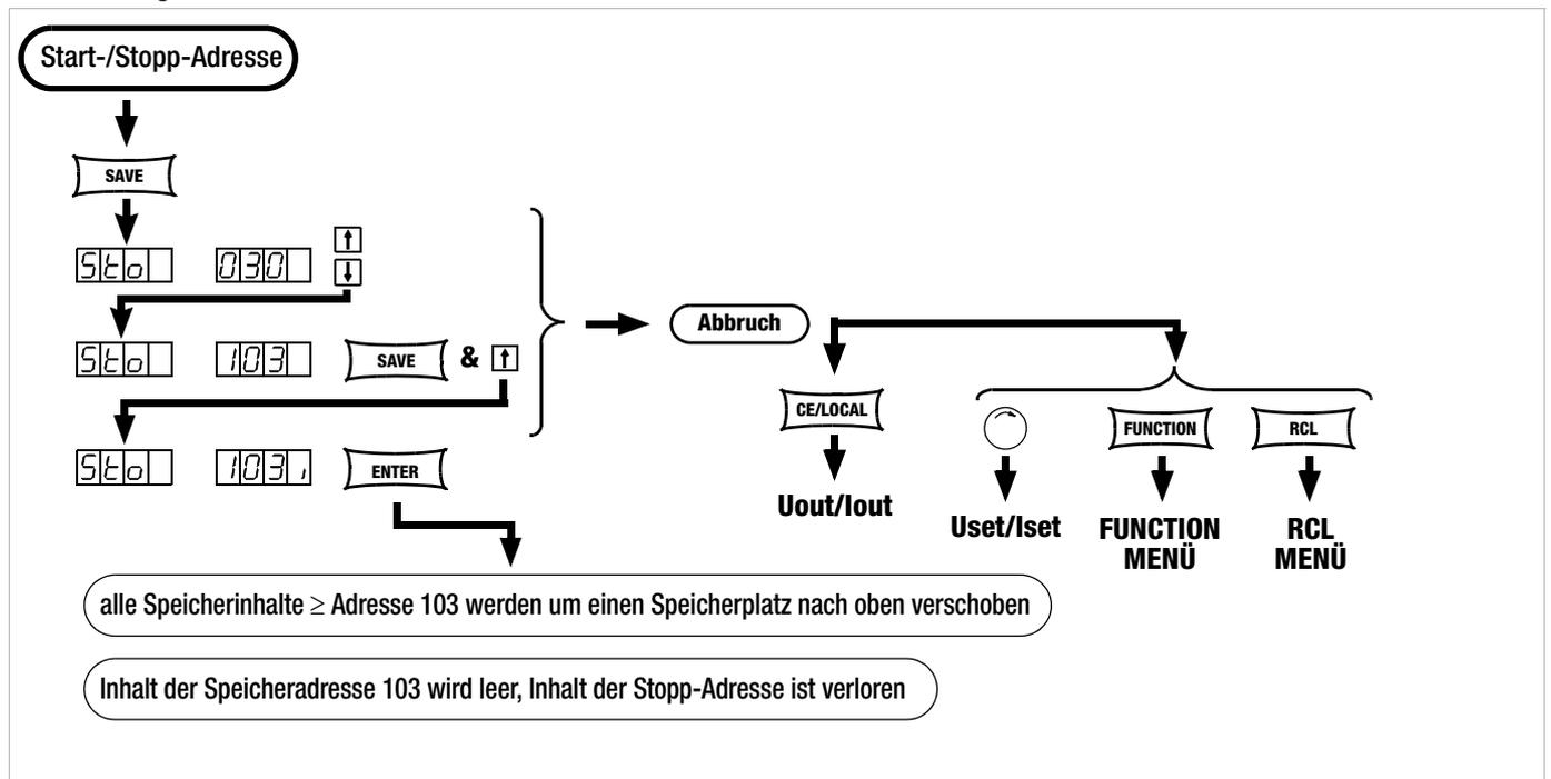
Bild 4.9.4 Einfügen eines leeren Speicherplatzes in einen Speicherbereich
