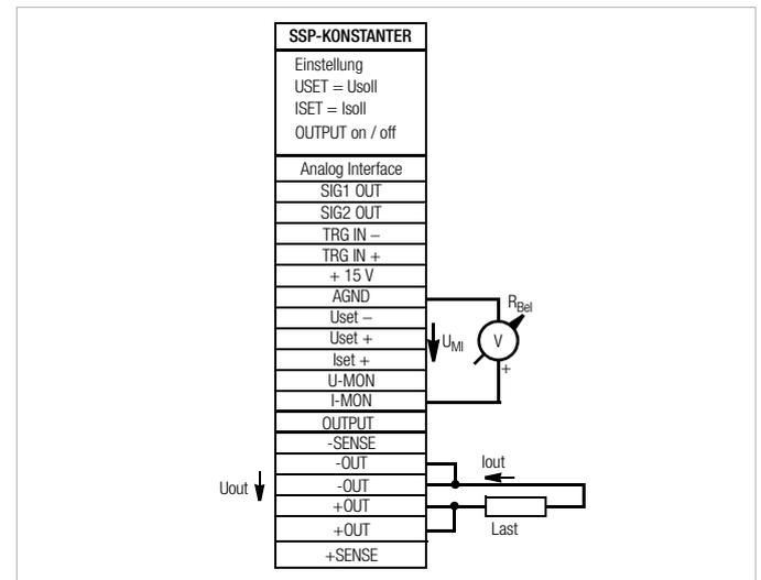
Bild 5.7 Verdrahtung Strommonitor
