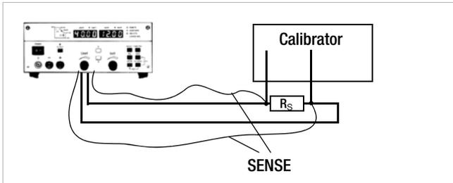
Bild 7.2 b Anschlusschema für Justieren des Ausgangsstromes
