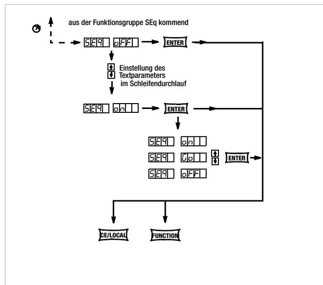
Bild 4.7.3 l SEQUENCE vorbereiten bei Software < REL. 003
