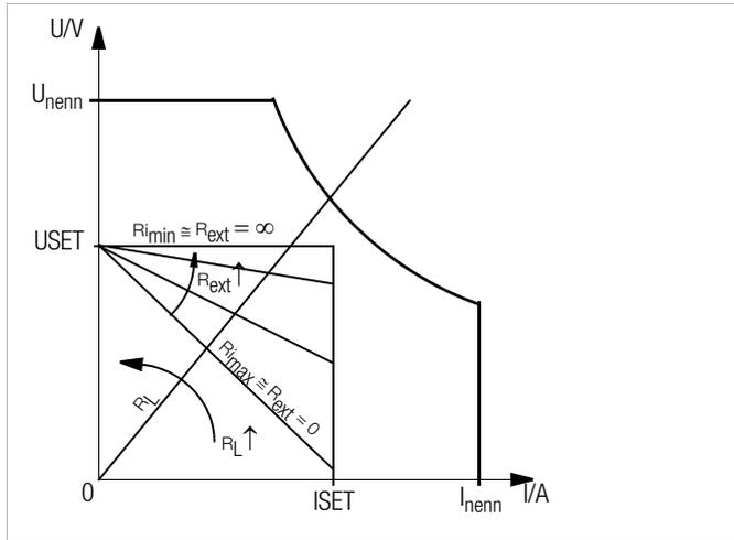
Bild 5.11 a Abhängigkeit der Ausgangsspannung von der Belastung
