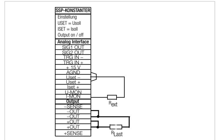
Bild 5.11 b Verdrahtung zum Variieren des Innenwiderstandes
