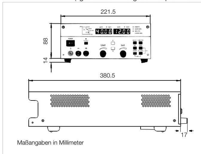
Bild 1.5 Maßzeichnung (Tischgerät)
