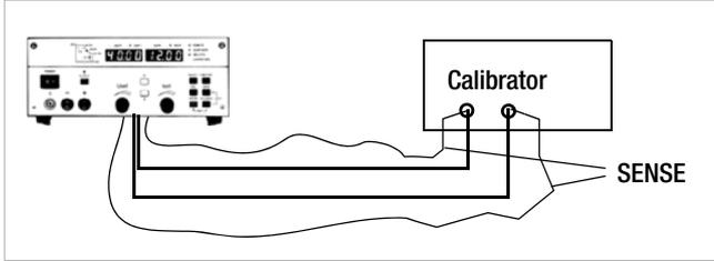
Bild 7.2 a Anschlusschema für Justieren der Ausgangsspannung
