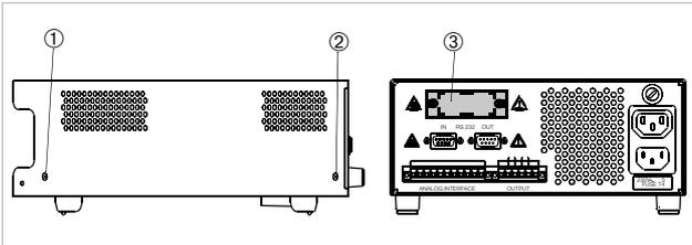
Bild 2.1.1 a Öffnen des KONSTANTER-Gehäuses
