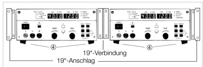
Bild 2.1.2 b Rack-Umbau für zwei KONSTANTER
