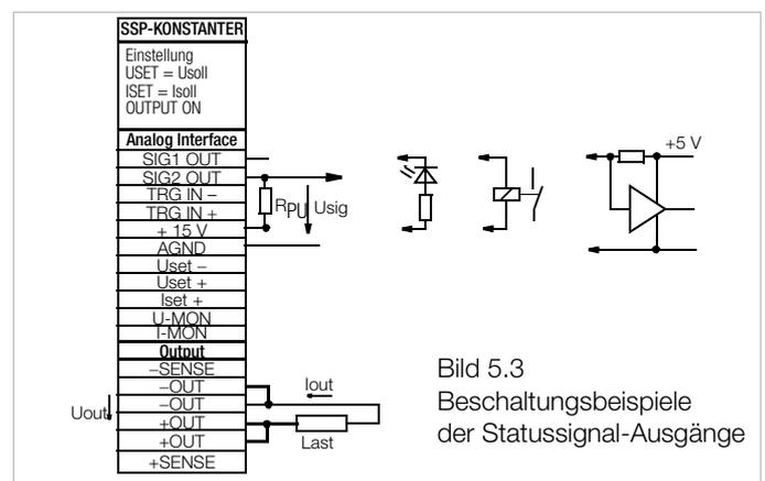
Bild 5.3 Beschaltungsbeispiele der Statussignal-Ausgänge
