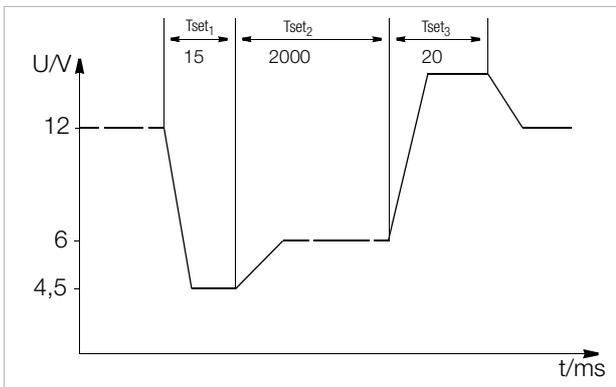
Bild 4.7.3 a Prüfsignal zur Bordnetz-Simulation beim Anlassvorgang
