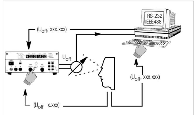
Bild 7.1 b Justieren des KONSTANTERS per Hand oder PC
