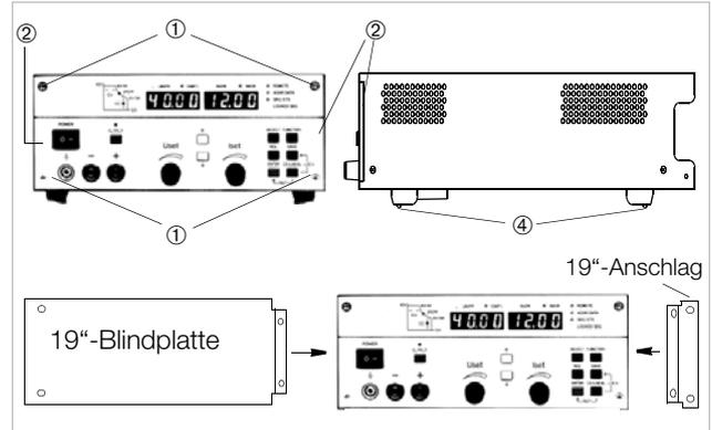
Bild 2.1.2 a Rack-Umbau eines einzelnen KONSTANTERs
