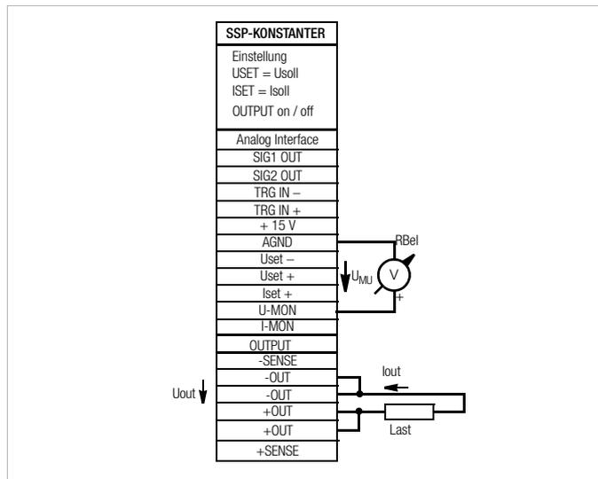
Bild 5.6 Verdrahtung Spannungsmonitor
