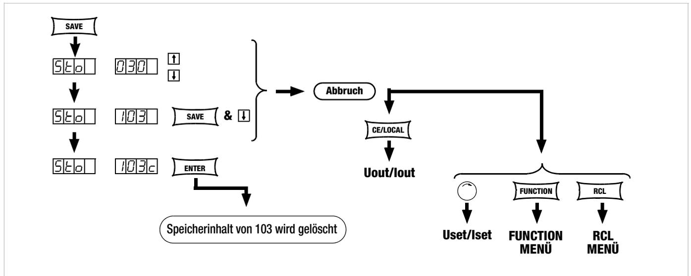
Bild 4.9.6 Löschen des Inhaltes eines einzelnen Speicherplatzes
