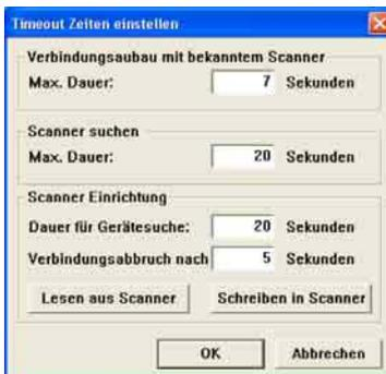
Die ersten beiden Einstellungen betreffen die Suchzeiten bei Verbindungsaufbau zwischen dem USB-Bluetooth-Stick am PC und dem **SCANWRITE RFID**.
