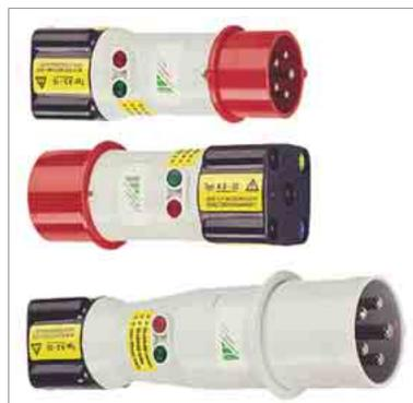
Die Drehstromadapter A3-16, A3-32 und A3-63 dienen dem problemlosen Anschließen von Prüfgeräten an 5-polige CEE-Steckdosen. Die drei Ausführungen unterscheiden sich durch die Größe des Steckers, der jeweils den 5-poligen CEE-Steckdosen mit den Nennströmen 16 A, 32 A, 63 A entspricht. Die Phasenfolge wird jeweils durch Lampen signalisiert.
