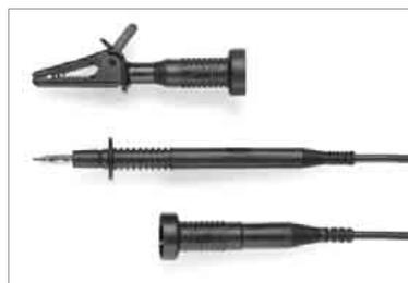
Das Kabelset KS 24 besteht aus einem 4 m langen Verlängerungskabel mit fest angeschlossener Prüfspitze an einem Ende und einer berührungsgeschützten Buchse am anderen Ende sowie zwei auf die Prüfspitze aufsteckbaren Krokodilclips.
