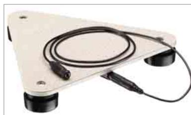
Die Fußbodensonde 1081 ermöglicht die Messung des Widerstands isolierender Fußböden gemäß DIN VDE 0100 Teil 610 und EN 1081.
