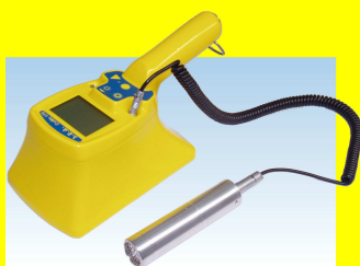
CoMo mit angeschlossenem Detektor zur Dosisleistungsmessung
