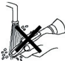
• Refraktometer nie unter fließendem Wasser reinigen. Das Gerät könnte dadurch beschädigt werden.
