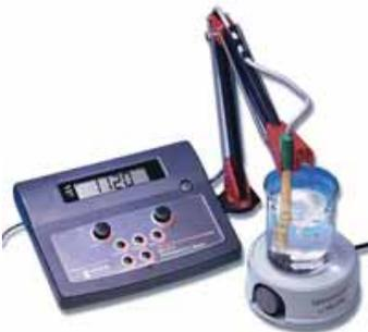
EC 215 verfügt über 4 Leitfähigkeitsmessbereiche und wurde für Labormessungen hoher Präzision entwickelt. Die mitgelieferte 4-Ring-Sonde ermöglicht schnelle Messungen in allen 4 Bereichen, ohne Sondenwechsel. Modell EC 215R hat zusätzlich einen analogen 0-5 V Ausgang.
