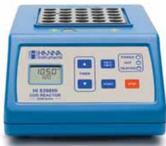
Der Thermoreaktor **HI 839800** ermöglicht den gleichzeitigen Aufschluss von 25 Fertigküvetten. Die Temperatur ist einstellbar, und zwar auf 150 °C für CSB, bzw. auf 105 °C für Gesamtstickstoff. Bei Erreichen der gewünschten Temperatur leuchtet ein LED auf.
