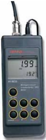
HI 9835 misst gleichzeitig Leitfähigkeit (6 Messbereiche), TDS (6 Messbereiche) und Natriumchlorid (Meerwasser). Die Parameterauswahl erfolgt automatisch. Wasserdicht, im Transportkoffer, ist HI 9835 bestens für Outdoor-Messungen und schwieriges Umfeld (Feuchtigkeit, Staub ...) geeignet.
