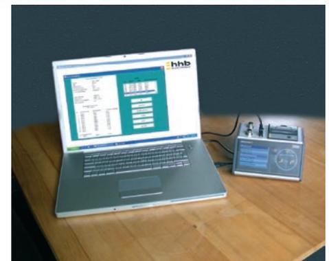
Nachlaufzeit, Nachlaufweg und der errechnete Sicherheitsabstand werden direkt nach jeder Einzelmessung angezeigt. Ein Messprotokoll mit allen Angaben wird erstellt und automatisch im Messgerät gespeichert. Zeitunabhängig können die Daten von einem PC ausgelesen werden.
