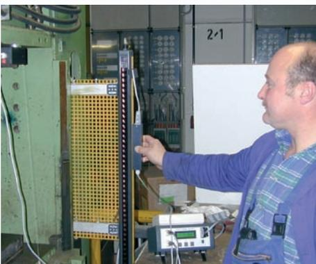
Der Aktuator wird zum Auslösen der Schutzeinrichtung vorbereitet - ganz ohne elektrischen Anschluss an die Maschine. Ob Lichtvorhang, Scanner, Zweihandschaltung oder andere Schutzeinrichtungen, der Aktuator Auto-Hand ist geeignet diese auszulösen.
