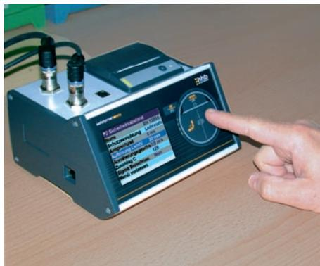
Zur richtigen Berechnung des Sicherheitsabstandes werden Art und Spezifikationen der Schutzeinrichtung vom Messgerät in einem leicht zu bedienenden Menü abgefragt.
