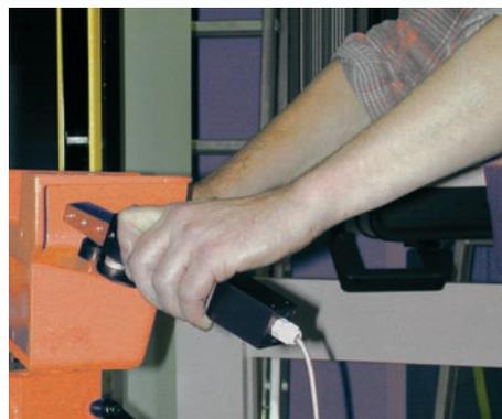
Zur Messung wird die Maschine angefahren, bis sie die höchste Geschwindigkeit erreicht hat. In dieser Position erfolgt das Auslösen der Schutzeinrichtung und die Messung der Nachlaufzeit.
