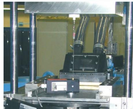
Der Wegsensor ist einfach mit Haftmagneten an der Maschine anzubringen. Er erfasst die Maschinenbewegung. Für Drehbewegungen stehen Reibrad-Encoder zur Verfügung.
