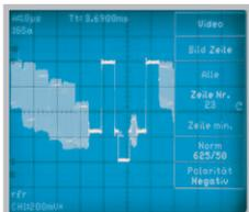
Digitalbetrieb: Fernseh-Halb-bild und daraus „gezoomte“ Zeile
