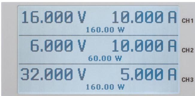
Abb. 4.2: Einstellbare Maximalwerte HMP4030
