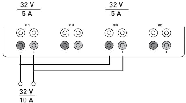
Abb. 7.3: Parallelbetrieb (schematische Darstellung)
