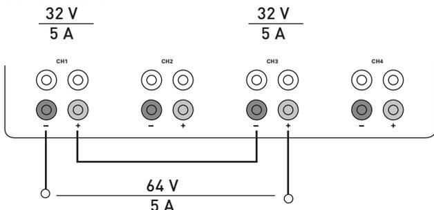
Abb. 7.2: Serienbetrieb (schematische Darstellung)
