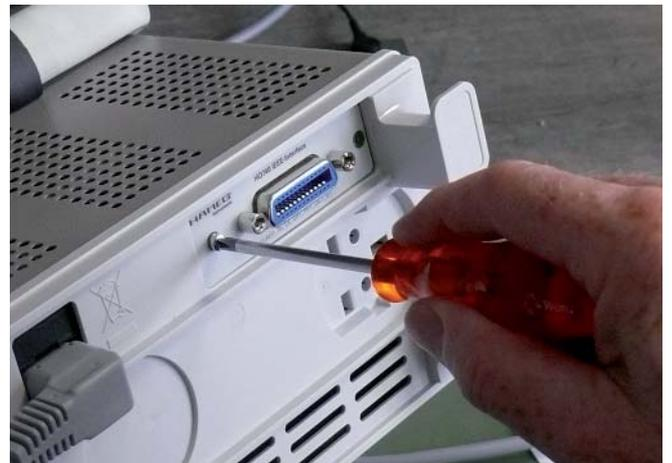
5.2.2 Befestigen Sie das Interface mit den vorher entfernten (Punkt 5.1.1) Befestigungsschrauben.
