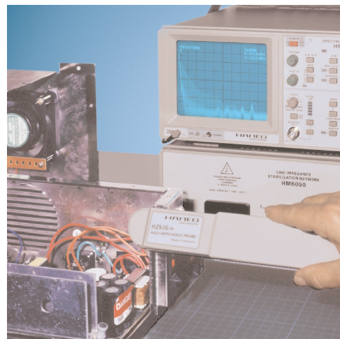
Bild 1 Ermittlung der abgestrahlten Stör- energie mit Hilfe einer Magnetfeld- sonde (H-Feld-Sonde) und eines Spek- trumanalysators.
