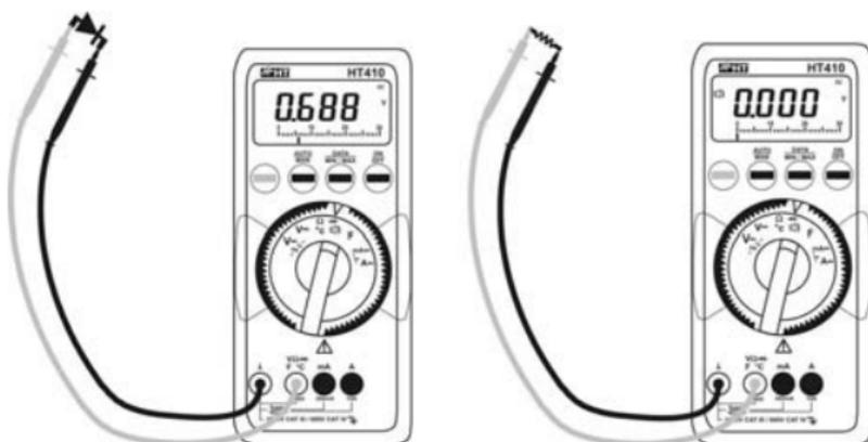
Abb. 8: Diodentest und Durchgangstest
