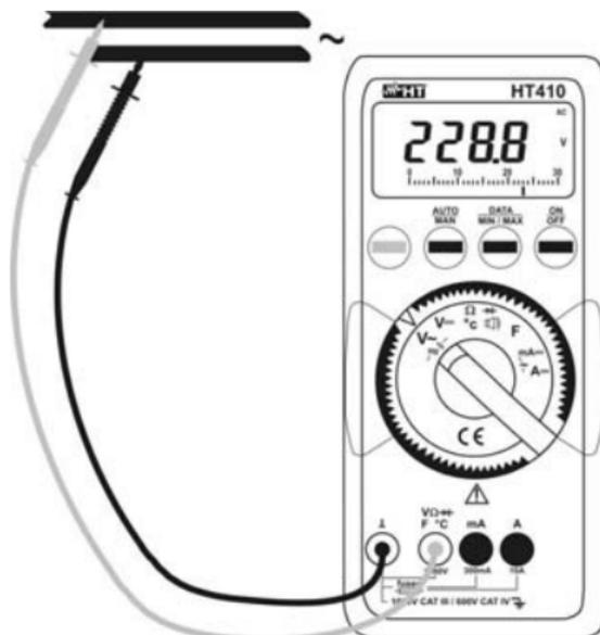
Abb. 4: AC Spannungsmessung
