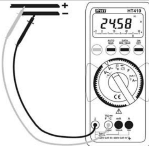
Abb. 3: DC Spannungsmessung
