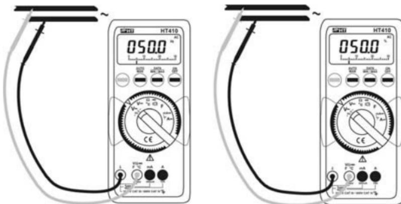
Abb. 5: Messung von Frequenz und Tastverhältnis
