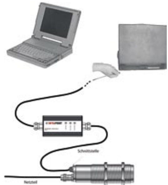
Abb.: Anschlussbeispiel: IKS-TI - IP 10-USB - Laptop
